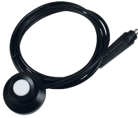
조도 프로브 (SLU) 측정 범위 : 0 ~ 150,000 lux 0 ~ 13,935 fc
